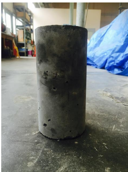
写真7. 普通のコンクリート供試体
