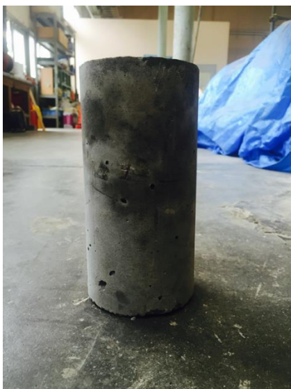
写真7. 普通のコンクリート供試体
