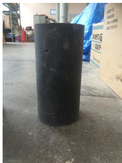
写真8. 超高強度コンクリート供試体
