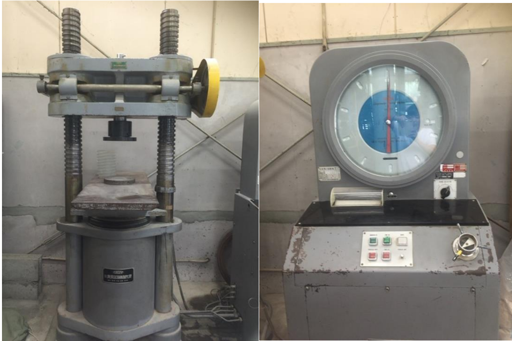
写真5 6. コンクリート圧縮試験機
